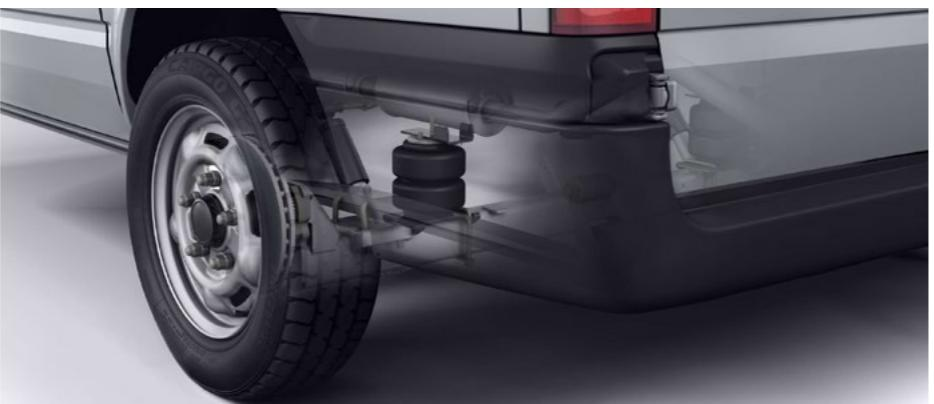
Augmenter la garde au sol      Réduire le fléchissement      Diminuer l'inclinaison      Améliorer le confort de conduite      Améliorer la tenue de conduite      Réglage automatique
